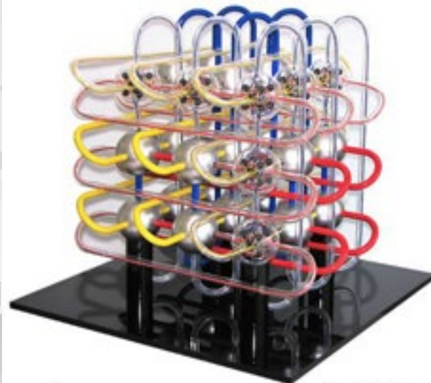
6次元メッシュ/トラス(概念模型) TOFUネットワーク
