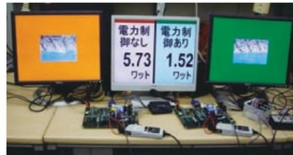
図16 現状：世界唯一コンパイラによる消費電力削減に成功
