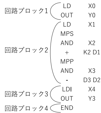
図 2 図 1 に対応するラダーインストラクションリストの例 Fig. 2 An example of a Ladder instruction list for Fig. 1.
