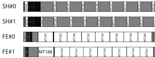
図 7 2SH+2FE 構成時の実行トレース結果 (周波数及び電源制御無)
