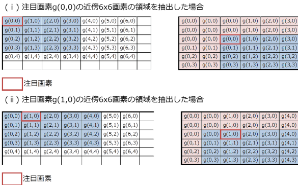
図 5 6x6 フィルタをかける前処理の拡張コピーの例
